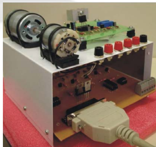
Figura 4 - Módulo Taco-Gerador desenvolvido para implementação de estratégias de controle diferenciadas
